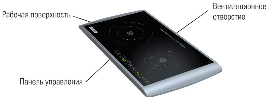
Работа индукционной плиты основана на принципе электромагнитной индукции. Электрический ток, проходя через катушку, преобразуется в переменное магнитное поле. Переменное магнитное поле способно порождать изменяющееся электрическое поле (индукционный ток). Обладающая ферромагнитными свойствами посуда представляет собой проводник с замкнутым контуром. Под воздействием вихревого индукционного тока электроны дна посуды приходят в движение, что приводит к выделению тепловой энергии
